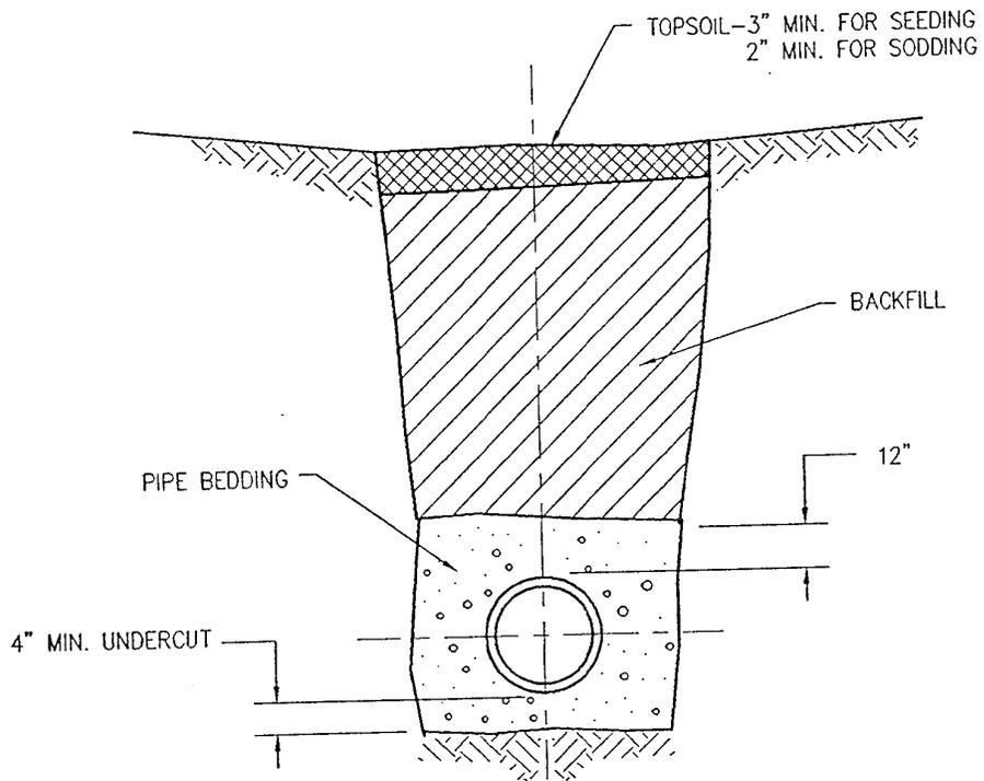
**NORMAL TRENCH BACKFILL**
